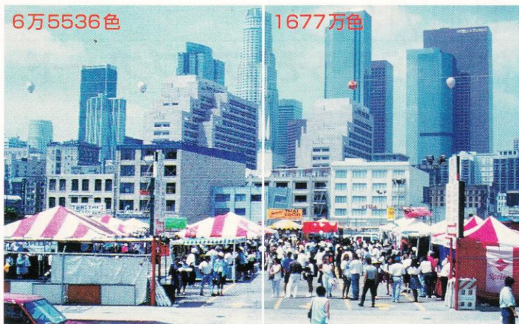
●図2 実際にグラフィックス・ボードによってどれくらい表示画像が変わるかを見た。1024×768に解像度を固定し、最大色数で表示した。左側はグラフィックス・ボードなし（色数：6万5536色）、右側があり（色数：1677万色）。印刷では分かりにくいかもしれないが、画面上で1677万色表示を見ると、階調のなめらかさは明らかだ
